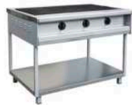
Плита электрическая 3-х конфорочная без жарочного шкафа (1095x830x865(885) мм, 12кВт, 380В)
